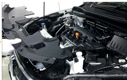
2. 拆下前格栅顶盖
