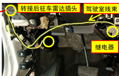
24. 布置驾驶室线束，将6极插头转接在后驻车雷达插头上，用扎带将继电器固定在方向盘右下方支架上。
