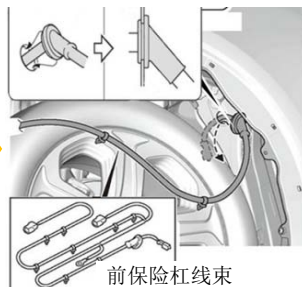
19. 将前保险杠线束从翼子板钣金孔穿入驾驶室
